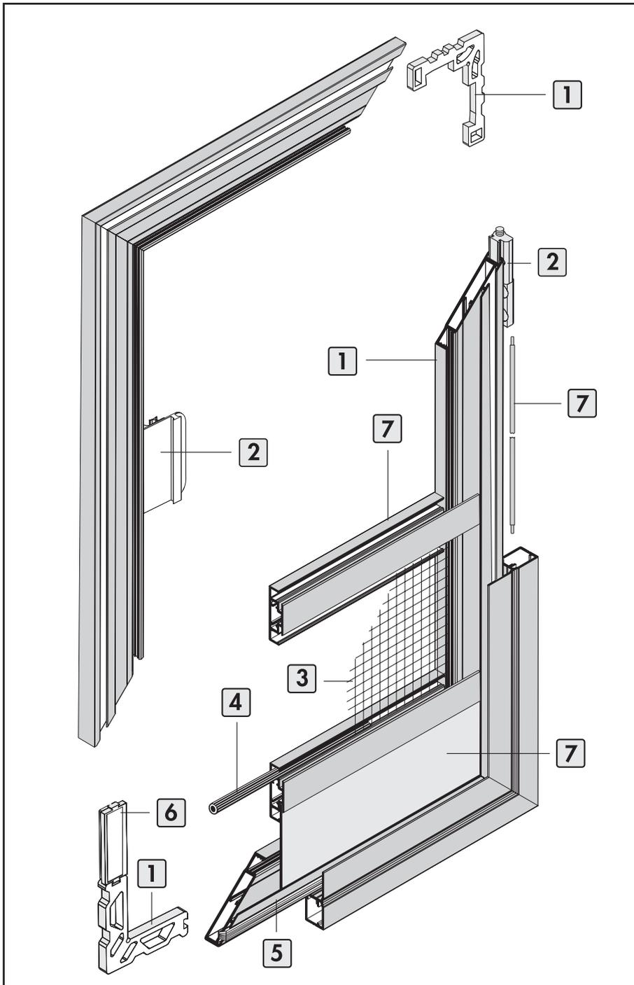
**7** Alle Türvarianten werden mit einer gewebeteilenden Mittelsprosse und einem Sockelblech versehen. Diese Bauteile verhelfen der Tür zu einer sehr hohen Stabilität. Die Sprossenhöhe kann variabel angegeben werden (Standardmaß = 102 cm, Unterkante Flügel bis Mitte Sprosse). Auf Wunsch können alle Türen mit einem Türschließer (Torsionsstab) ausgerüstet werden.
